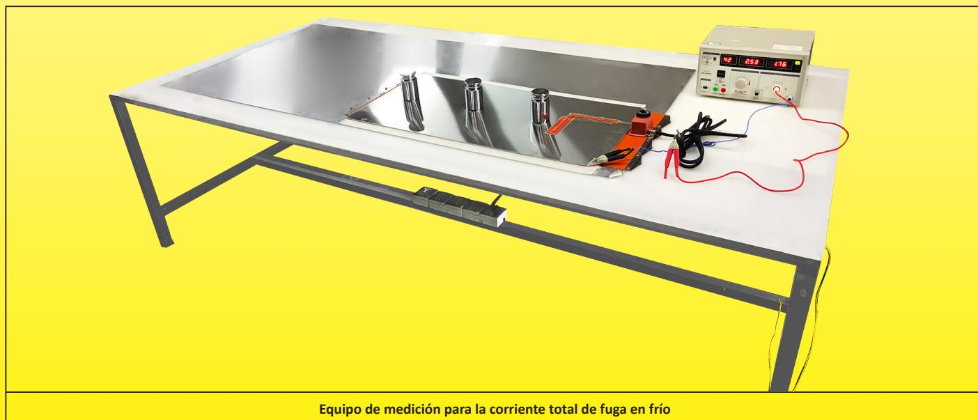
Equipo de medición para la corriente total de fuga en frío
